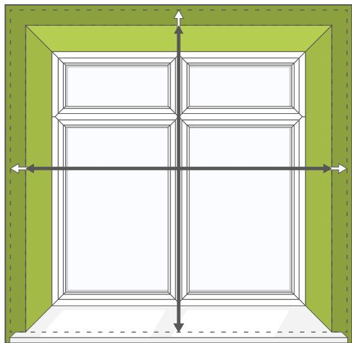
「正面付け※」は窓枠を覆うように取り付ける方法です。窓枠よりもサイズを大きくすることで、隙間からの光漏れが少なく、遮光に優れているのが特徴です。窓が大きく見える点もメリットです。
