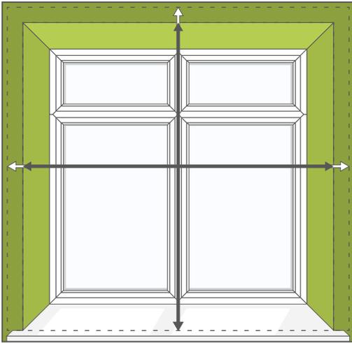
「正面付け※」は窓枠を覆うように取り付ける方法です。窓枠よりもサイズを大きくすることで、隙間からの光漏れが少なく、遮光に優れているのが特徴です。窓が大きく見える点もメリットです。
