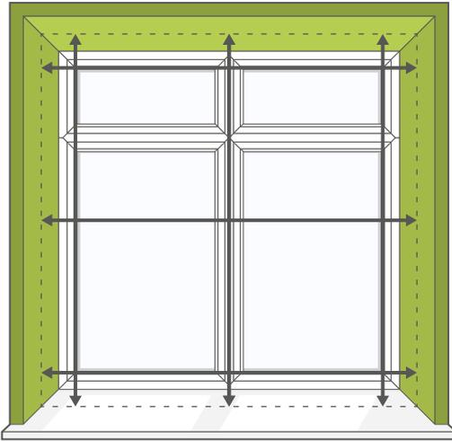
「天井付け※」は窓枠内側におさめる取り付け方法です。本体上部のメカ部分や本体が全て窓枠内に収まるので、すっきりとした印象になるのが特徴です。周囲に家具などを置いた時に干渉しない点もメリットです。
