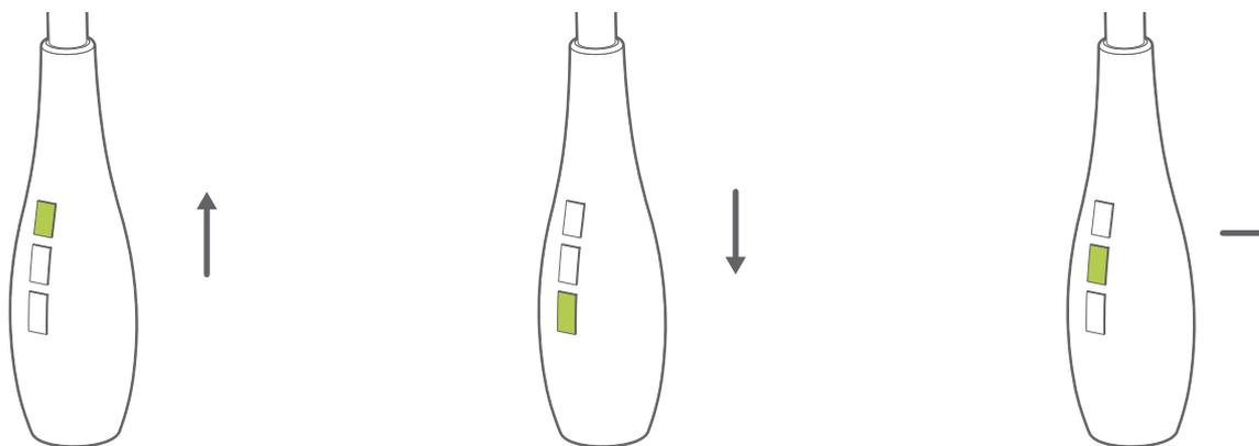
電動操作ワンドのハンドルについているボタンを押してスクリーンを操作します。上のボタンを押すと上がります。下のボタンを押すと下がります。真ん中のボタンを押すとスクリーンは停止します。
