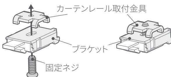
カーテンレール取付金具をブラケットの上に置き、固定ネジをドライバーで仮止めする。
