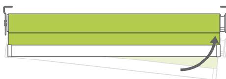
ブラケットの取り付けが終了したら、「ピンエンド」(上記参照)をブラケットに合わせます。そのあとコントロール側を反対側のブラケットに取り付け固定します。
