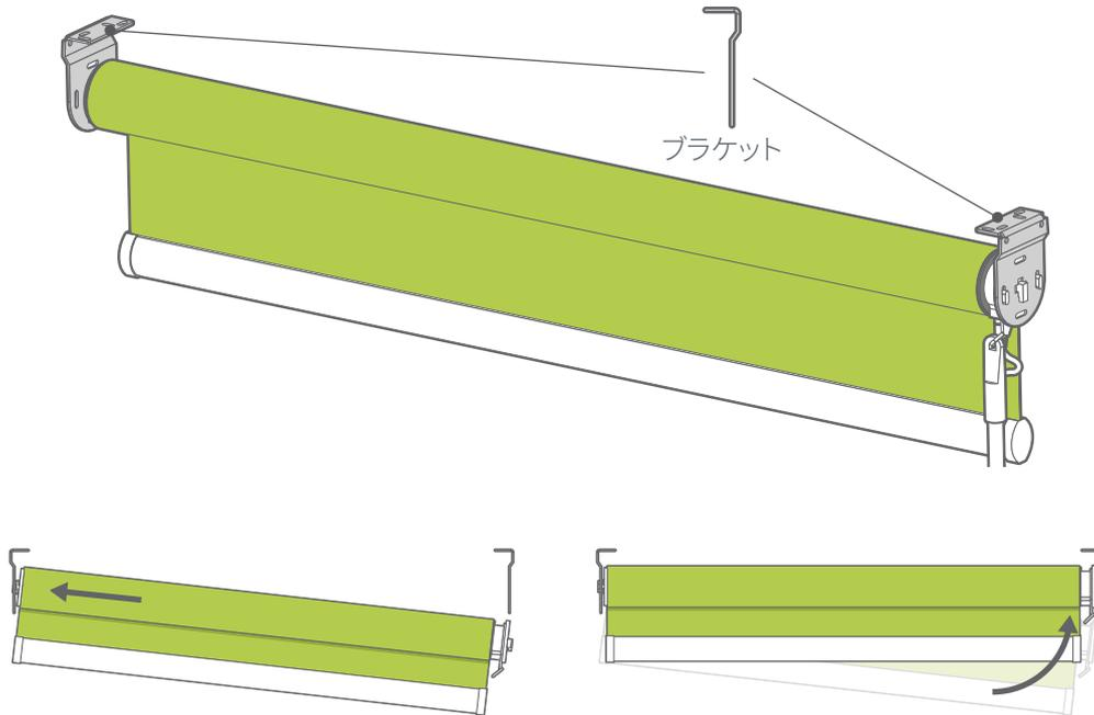
ロールスクリーンを上まで巻き上げた状態で、ピンエンドをブラケットに合わせます。そのあと、コントローラー側を反対側のブラケットに取り付け固定します。
