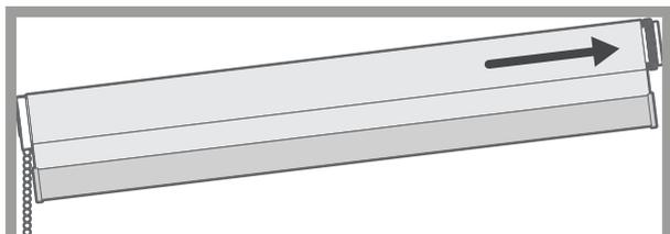
バネを縮めた状態で、チェーンコントローラー側を上げて、ロールスクリーンがまっすぐ水平になるように調整します。バネの反力で窓枠に固定します。
