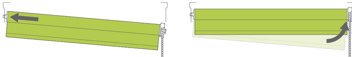
チェーンコントローラーと反対側の突起をブラケットの穴に合わせます。そのあと、チェーンコントローラー側をブラケットに合わせて固定します。
