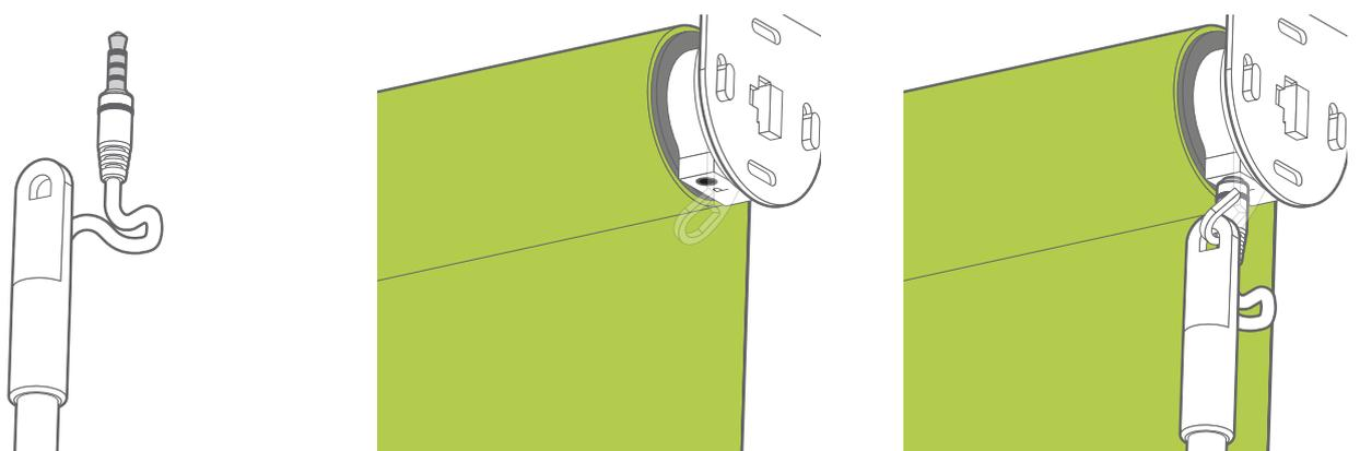
電動操作ワンドのプラグをポーターに差し込み、上部をフックに引っかけます。
