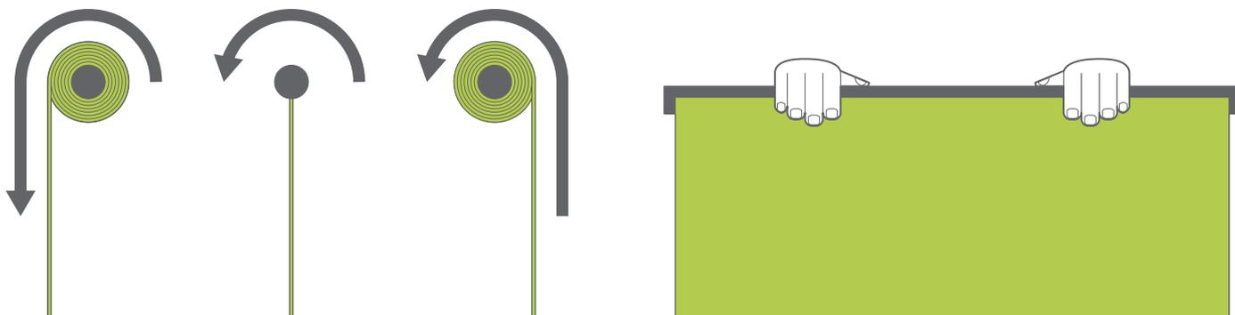
スクリーン生地の巻き方を変える場合は、まず現在巻いてある生地をすべて巻き出し、そのまま同方向にまき直します。その際、手のひらを滑らせて生地がしっかりとチューブに巻き付いていることを確認しながら巻いていきます。
