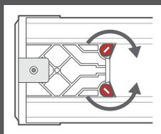
レール幅に微調整が必要な場合は、レバーと反対側にある、赤部分をマイナスドライバーで矢印のように中央に向かって回し、端の部品をレールから少し引き出してレールを伸ばして下さい。微調整後は、赤部分を戻し固定して下さい。
