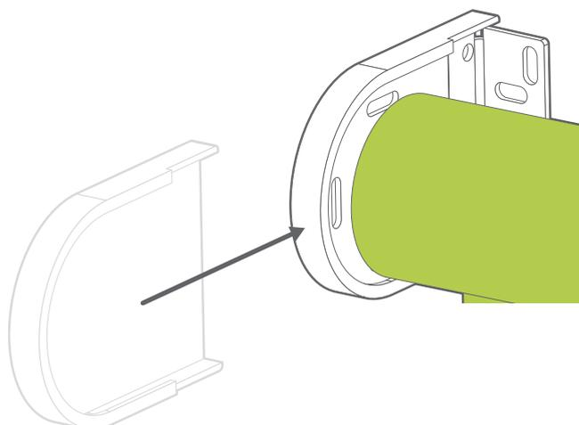
ブラケットカバーは、前方から後方に押し込むだけで簡単に装着できます。
