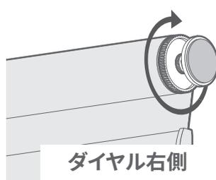
ダイヤルを、ロールスクリーンの筒に対して、時計回りに回し、突っ張りを伸ばします(左図参照)。回らなくなったら固定完了です。
