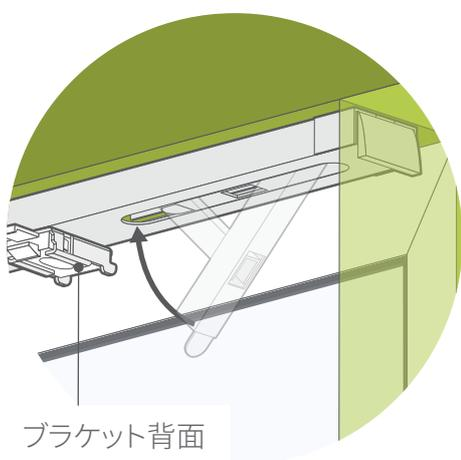
左図のようにブラケット背面を窓側へ向け、クリック2フィットを窓枠上部に水平に配置して、レバーをしっかりと押し上げます。
