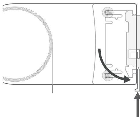
ブラケット下部のプラスチック部品を押しながら、ヘッドレールを下げて、はめ込みます。
