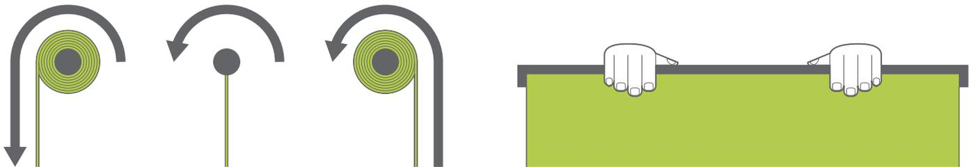
スクリーン生地の巻き方を変える場合は、まず現在巻いてある生地をすべて巻き出し、そのまま同方向にまき直します。その際、手のひらを滑らせて生地がしっかりとチューブに巻き付いていることを確認しながら巻いていきます。
