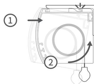
ヘッドレールの後ろ側を持ち上げ、ブラケット後部にはめ込み固定します。
