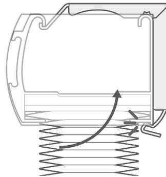
ヘッドレールの後ろ側を持ち上げ、ブラケット後側のくぼみ(凹部)にはめ込み固定します。
