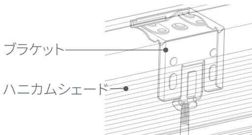
ハニカムシェード本体をブラケットから外すときは、本体後ろ側のブラケット下部にドライバーの先を挿入し、押し上げながら外します。
