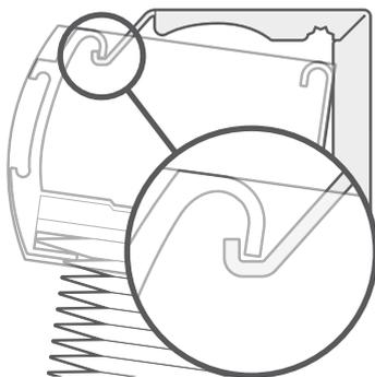
ヘッドレールの前側のツメ(凸部)をブラケットの前側のくぼみ(凹部)にはめ込みます。
