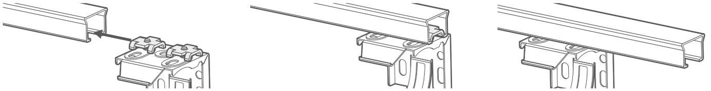
仮止めしたままカーテンレール取付金具をカーテンレールに挿入する。
