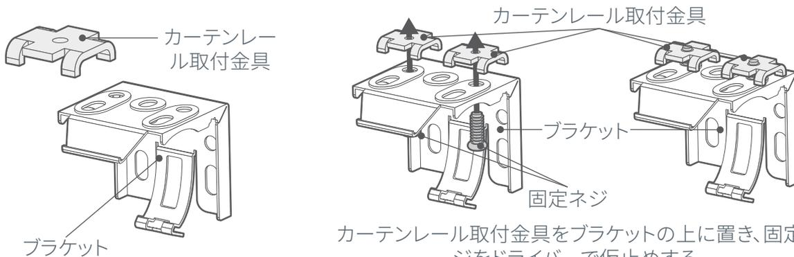
カーテンレール取付金具をブラケットの上に置き、固定ネジをドライバーで仮止めする。
