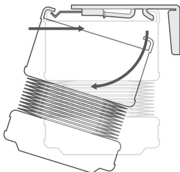
取り付けが完了した後でスクリーン本体をブラケットから外す場合は、まずヘッドレールの前側を押しながら後ろ側のヘッドレールを反転するように下に引くと本体がブラケットから外れます。
