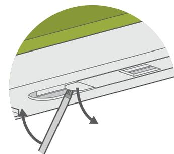
マイナスドライバーなどの細い工具をレバー横の隙間に差し込み、レバーを下方向に押し出します。※落下防止のため、レバーから離れた位置を片手で抑えながら作業を行ってください。またレバーが勢いよく下がりますので、ご注意ください。
