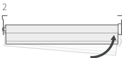
まずブラケットの下側にシアー生地をスタンダード巻きで取り付けます。バネ式になっているピン側を十字の穴に差し込みます。反対側を持ち上げチェーンを整えてからバネを押し込みながらコントロール側の突起部分をブラケットの溝にはめ込みます。
