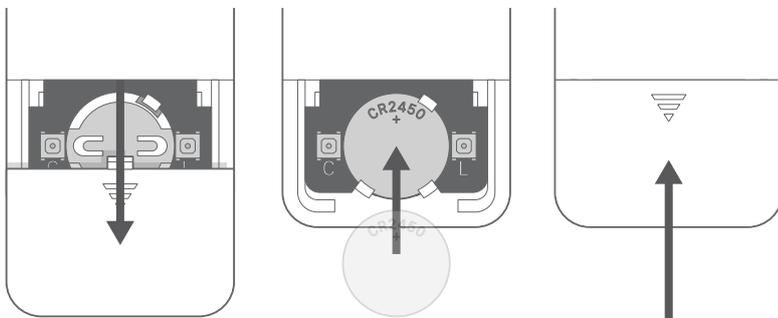
リモコンの電池は、リモコン裏側にある電池カバーをスライドして外し、付属のリチウムイオンバッテリーを丸いスロットに挿入します。
