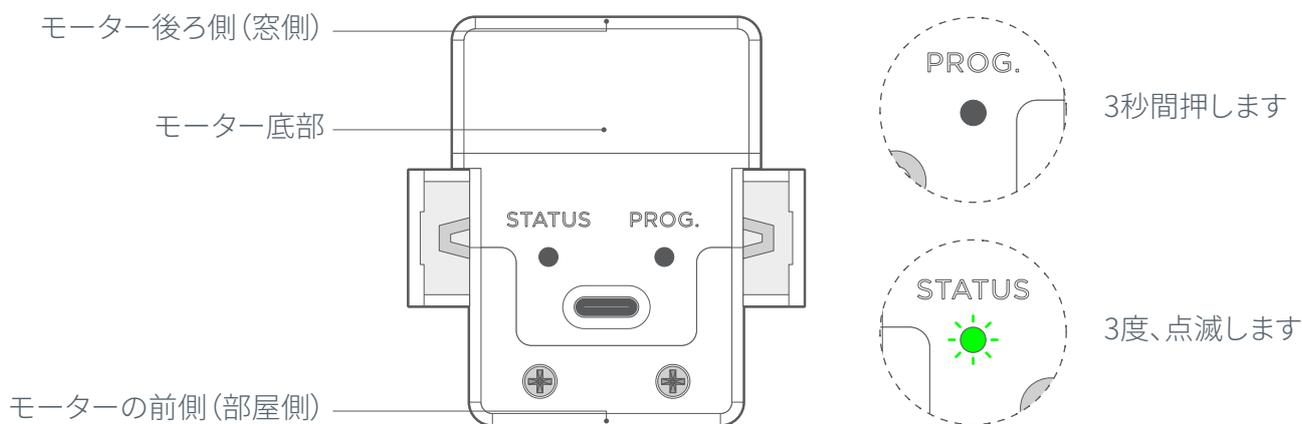
モーターは出荷時、スリープ状態になっているため、モーター下部の「PROG.(プログ)」ボタンを約3秒間長押しして解除してください。STATUS(ステータス)ランプが3回点滅すれば、モーターは使用可能になります。
