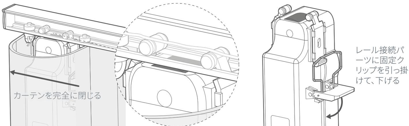
最初に取り外したレール接続パーツをカーテンレールの溝に差し込み、モーター本体の側面(もともと付いていた位置)に固定します。カーテンとモーターを一緒にスライドさせて、カーテンが完全に閉じた位置に合わせます。モーター両側の固定クリップをレール接続パーツの下部に引っ掛け、下げてしっかりとロックしてください。
