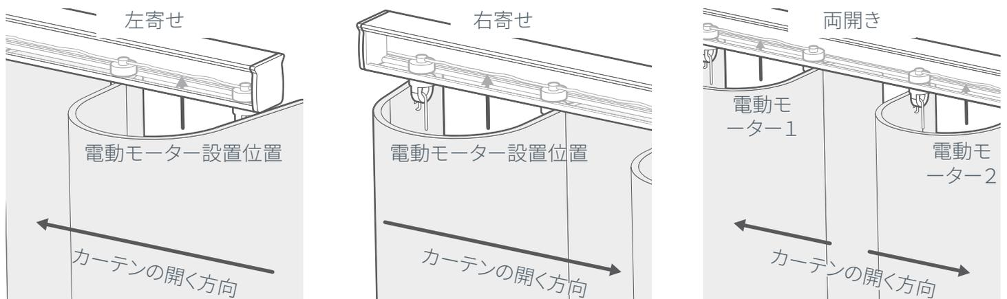
電動モーターの取付位置を確認します。片開きの場合は、カーテンが開く側の一番端にあるランナー2つの間（カーテンの裏側）にモーターを取り付けます。
