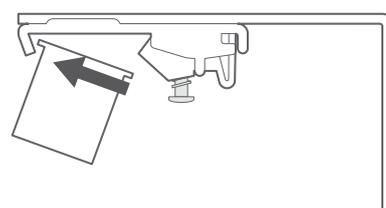
カーテンレールの前側のツメ(凸部)をブラケットのくぼみ(凹部)にはめ込みます。
