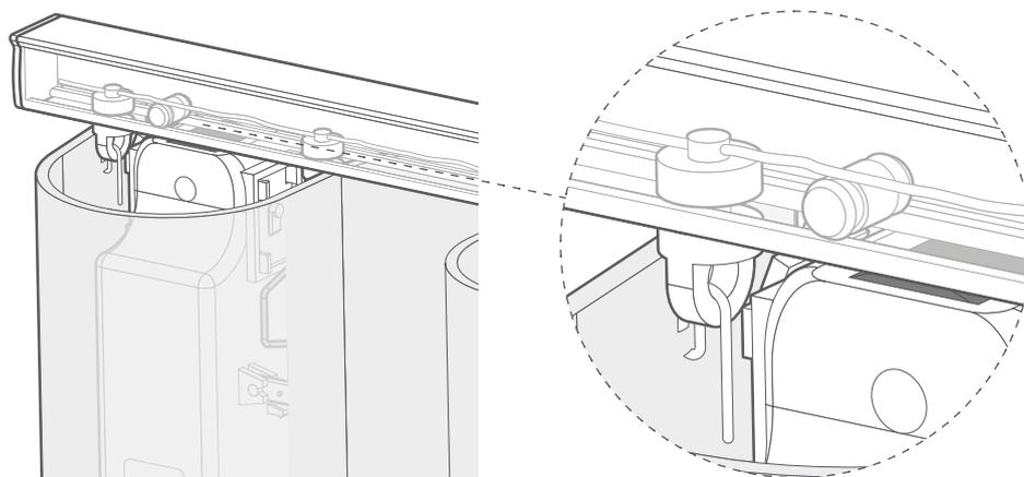
電動モーターを取り付けます。付けたままのレール接続パーツをカーテンレールの溝に差し込みます。
