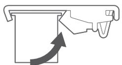
カーテンレールの後部を押し上げて後ろ側のツメ(凸部)を固定パーツにはめ込みます。
