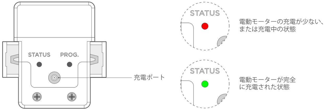
バッテリーを充電する際は、充電ケーブルを、モーター底部の充電ポートに差し込みます。バッテリーが空の状態から満充電になるまでには、約8時間かかります。
