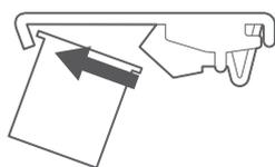
カーテンレールの前側のツメ(凸部)をブラケットのくぼみ(凹部)にはめ込みます。
