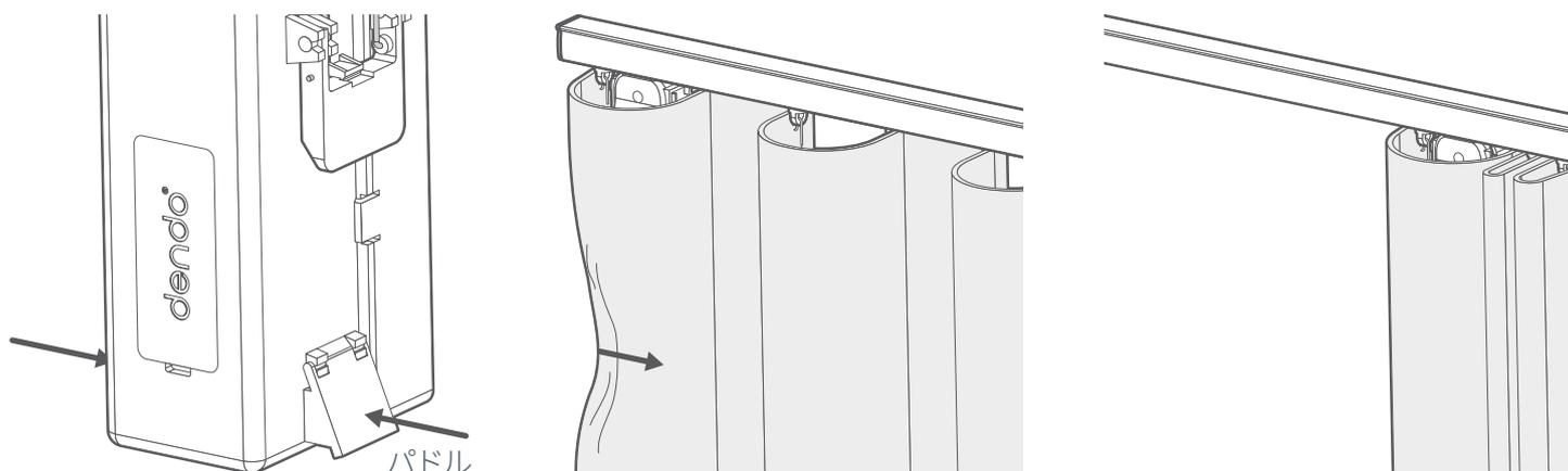
カーテンの全閉位置を設定します。カーテンが完全に閉じた状態で、モーター本体の側面にあるパドルを同時に押します。モーターが小さく動くと、全閉位置が記録されます。
