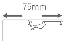
天井付け用のブラケットを取り付ける場合は、ブラケットの先端からビス付けをする壁までの幅が75mm以上あることをご確認ください。これはウェーブしたカーテン生地が窓や壁面に接触しないためのゆとりです。
