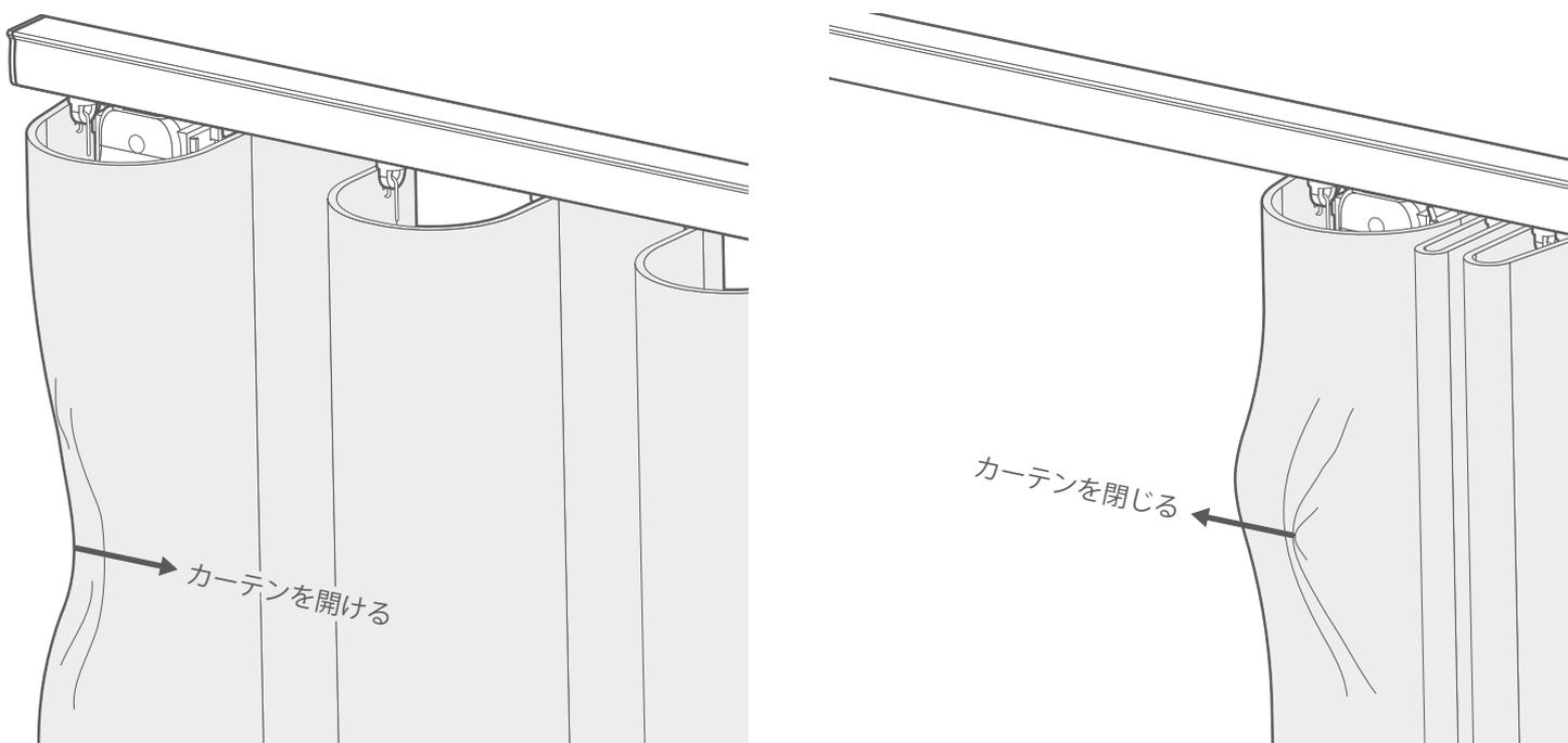
モーターを取り付けた後、カーテンを開けるときは、カーテンの端を開きたい方向に向かって強めに引きます。モーターが動きを感知し、自動でカーテンを全開まで開けます。
