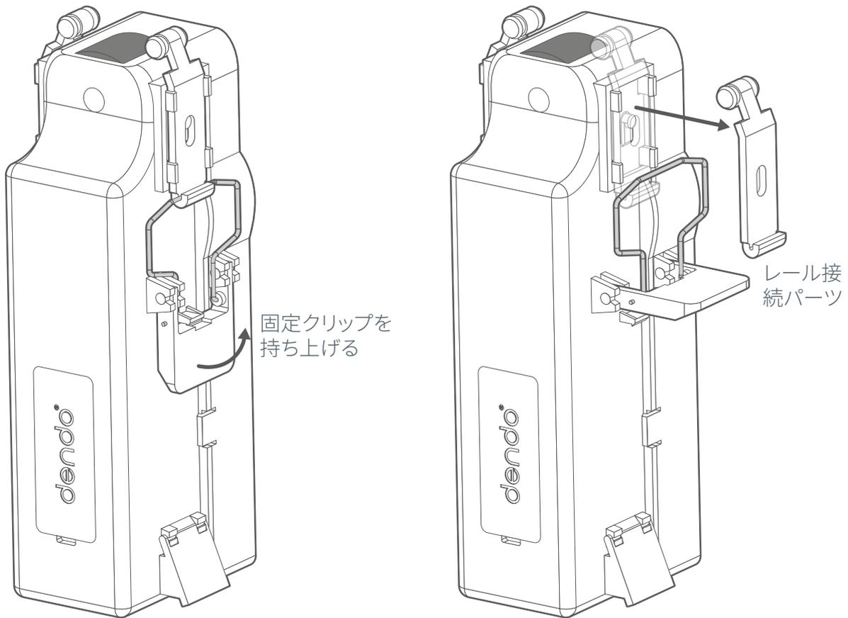
固定クリップを持ち上げて、レール接続パーツを1つ取り外します。もう一方は取り付けたままにしておきます。
