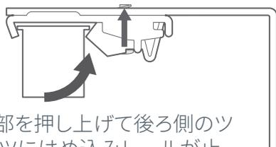
カーテンレールの後部を押し上げて後ろ側のツメ(凸部)を固定パーツにはめ込みレールが止まっていることを確認してビスをしめ、カーテンレールを固定します。
