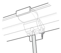
カーテンレールを取り付ける壁面に持ち上げてビス付け位置の印をつけます。
